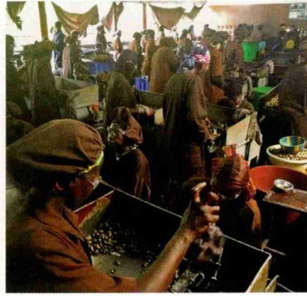
Nach dem Dämpfen wird die Schale der Cashew-Nüsse geknackt.
